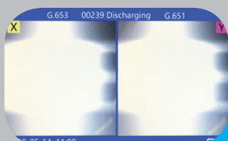
Giunzione stabile attenuazione minima
